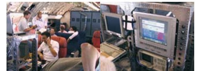
Test des Wireless-Cabin-Demonstrators in einem Airbus A340
