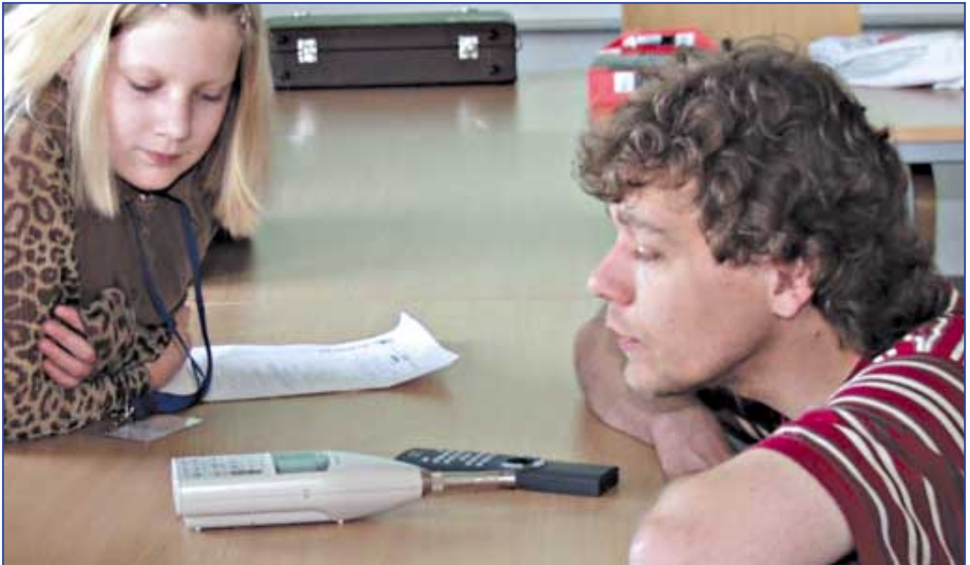
Messungen mit dem Schallpegelmesser
