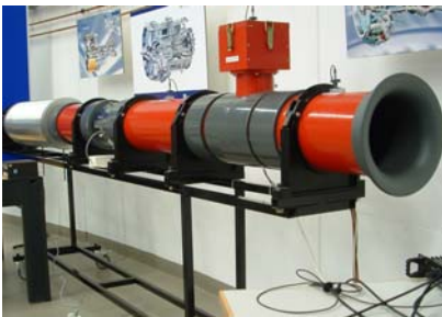
Abb. 9: Strömungskanal. In dem würfelförmigen Aufsatz ist der Lautsprecher für den Gegendenschall untergebracht.
