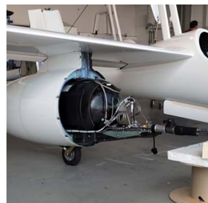
Abb. 9: ANTARES an der Wasserstofftankstelle
