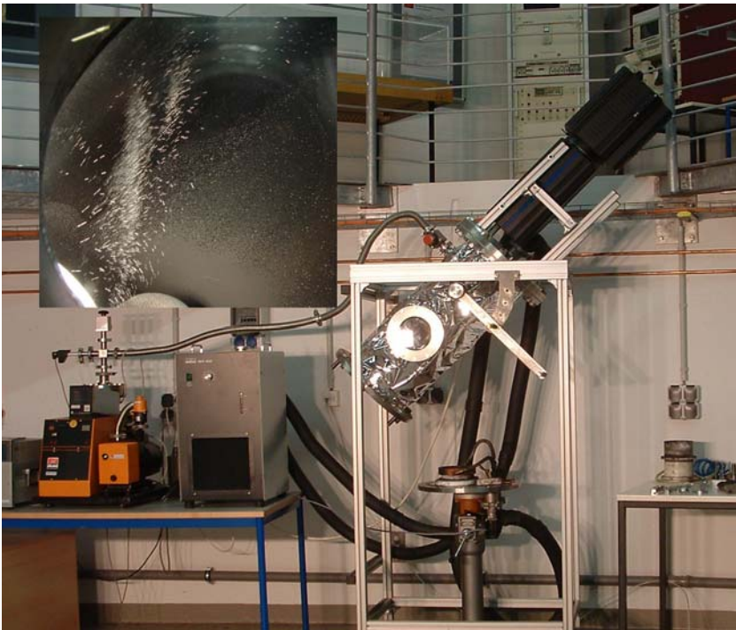
Versuchskammer zur Kometensimulation im DLR_School_Lab Köln
