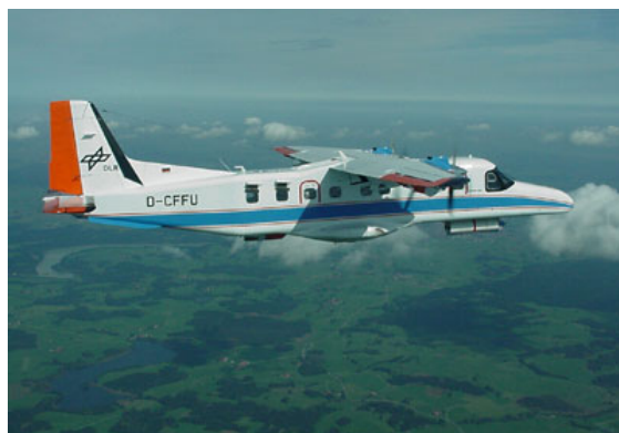
DLR Forschungsflugzeug ausgerüstet mit E-SAR (Synthetisches Apertur Radar System)
