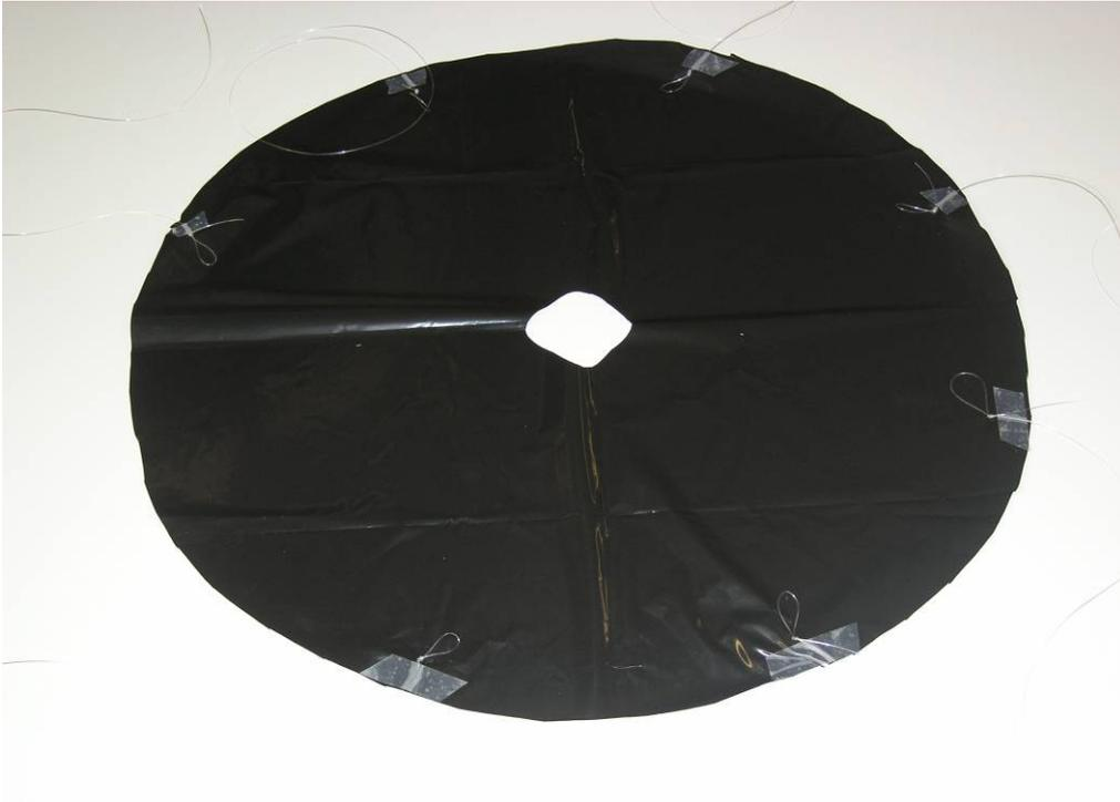
Die Fäden an der Knotenseite mit Tesafilm am Fallschirm befestigen und eine kleine Öffnung für die bessere Entfaltung des Schirms schneiden.
