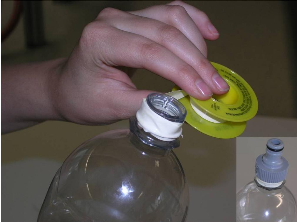
Zur besseren Abdichtung den Flaschenhals mit Teflonband umwickeln, dann den Gardena-Anschluß aufschrauben.
