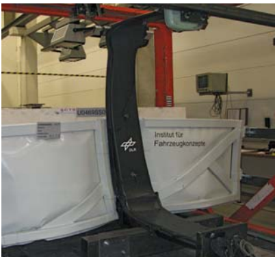
Bild: B-Säule eines Fahrzeugs in Spant-Space-Frame-Bauweise
