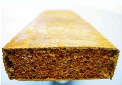
Bild: Silika-Aerogelgranulat gebunden mit RF-Aerogel und Baumwollgewebe
