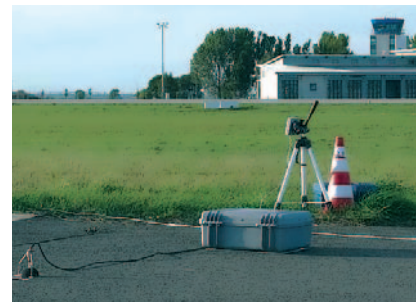
Messstation mit WLAN Antenne und Bodenmikrofon.
