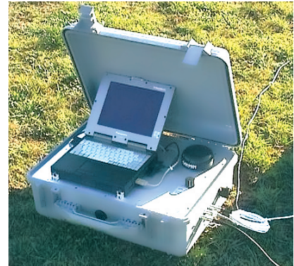
Zwei-Kanal Lärmmessstation mit wettergeschütztem Gehäuse.
