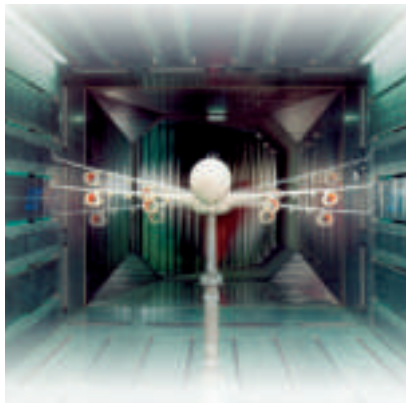
Geführte Rollbewegung eines A340 Modells im DNW-NWB.
