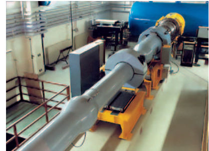
Das HEG Stoßrohr (grau), Düse (metallisch), Messstrecke (gelb) und Vakuumtank (blau).
