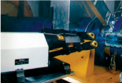
3-Komponenten Laser-2-Fokus Messung am Verdichterprüfstand.
