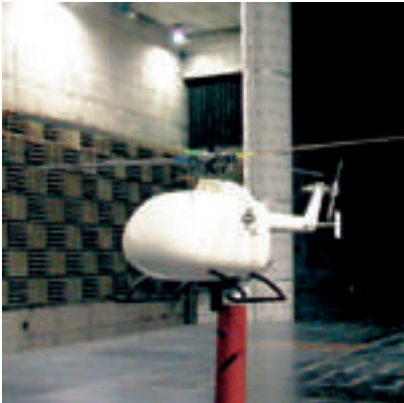
Modulares Windkanalmodell für Hubschrauberrotoren.
