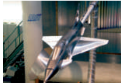
X-31 Remote-Control-Modell mit Heckstiel-Support.
