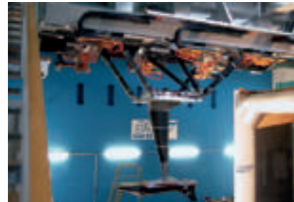
X-31 Remote-Control-Modell mit Bauchstiel auf dem MPM-System.
