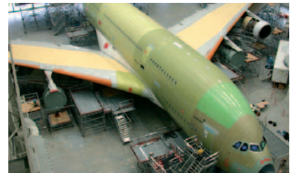
Standschwingungsversuch am Airbus A380.
