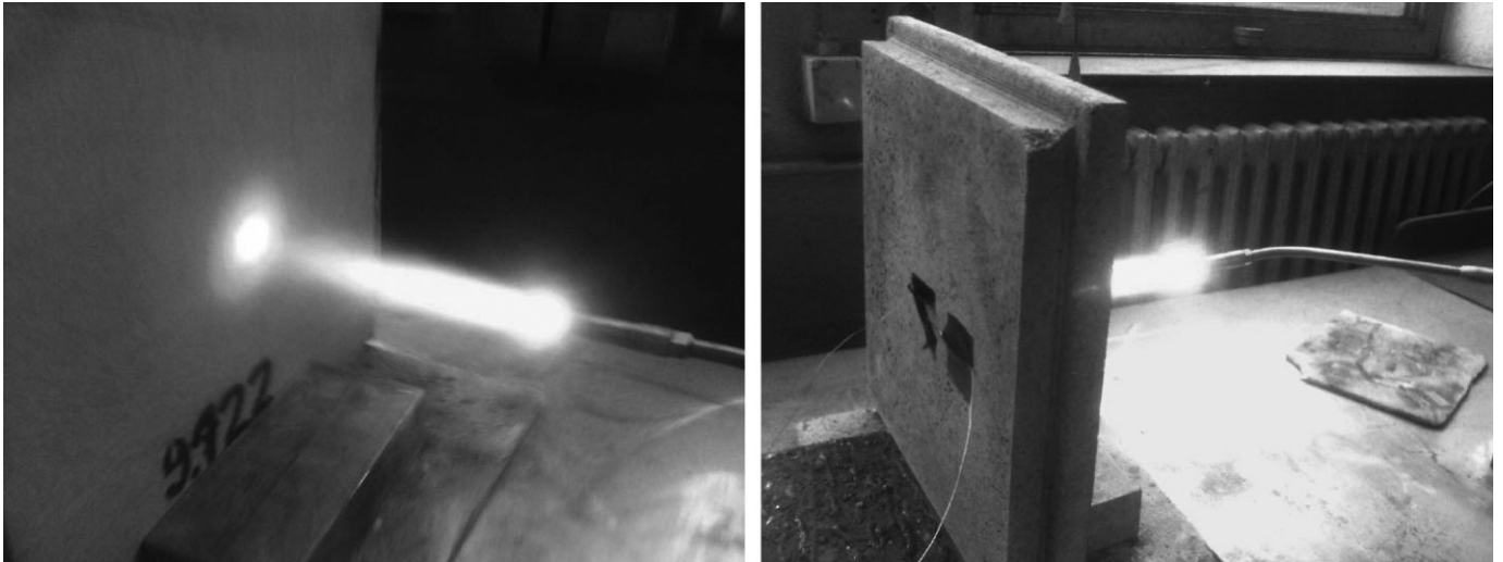
Bilder 8 und 9. Versuchsaufbau zur Überprüfung der Feuerfestigkeit eines Aerogelbetons Figs. 8 and 9. Real experimental set-up for the laboratory fire protections test
