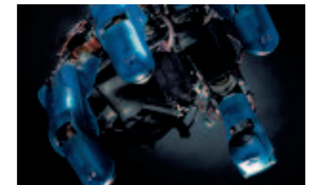
Leichtbauroboter mit 7 Roboterachsen und 13 Handantrieben
