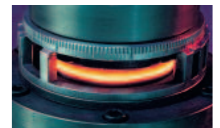
Hochleistungsbremsscheibe aus Faserkeramik
