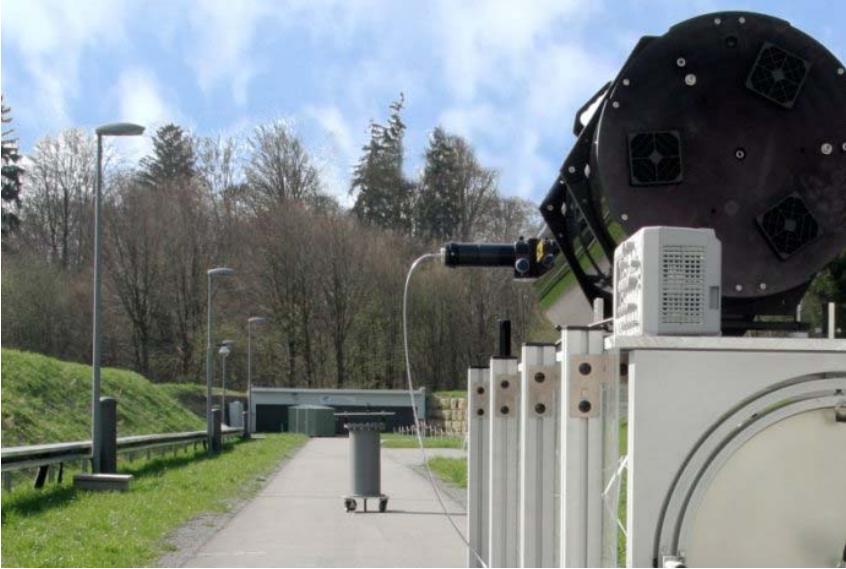
Lasergestützte Stand-off Detektion auf der Freistrahlstrecke.
