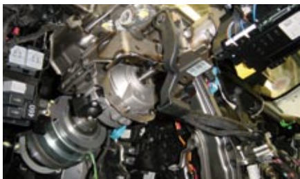
Die konventionelle Lenksäule wurde durch eine vom DLR entwickelte Steer-by-wire-Einheit mit Lenkmomentsteller und mechanischer Entkopplung ersetzt
