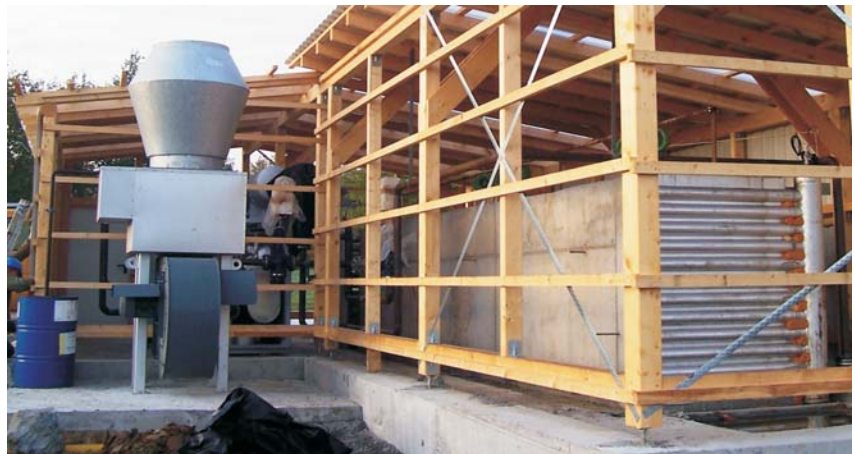
100 kW Speichertestanlage für Testbetrieb bis 400°C
