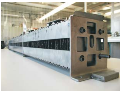
Wärmeübertrager für Sandwich-Speicherkonzept vor der Integration in das Speichermaterial
