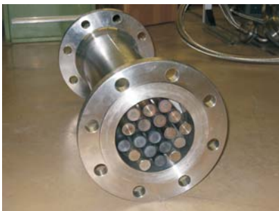
Speicherbehälter mit gekapseltem Latentspeichermaterial
