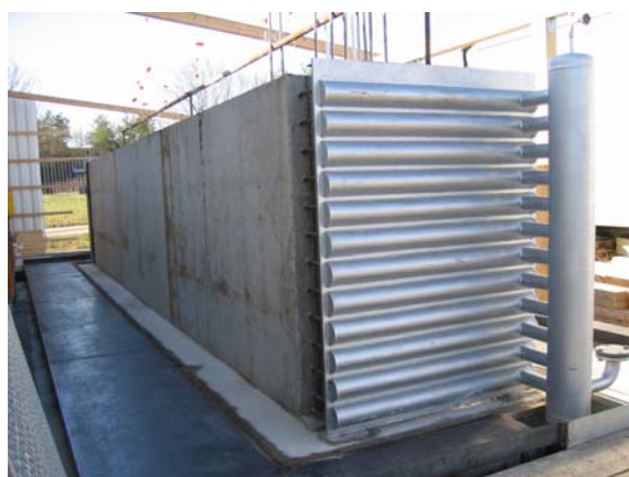
Abbildung 7 - Testmodul (ohne Wärmedämmung) auf dem Gelände der Universität Stuttgart
