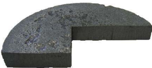
Beispiel eines Salz-Naturgraphit-Verbundmaterials: Lichtbild (links) und Schliff mit Mikrostruktur (rechts).
