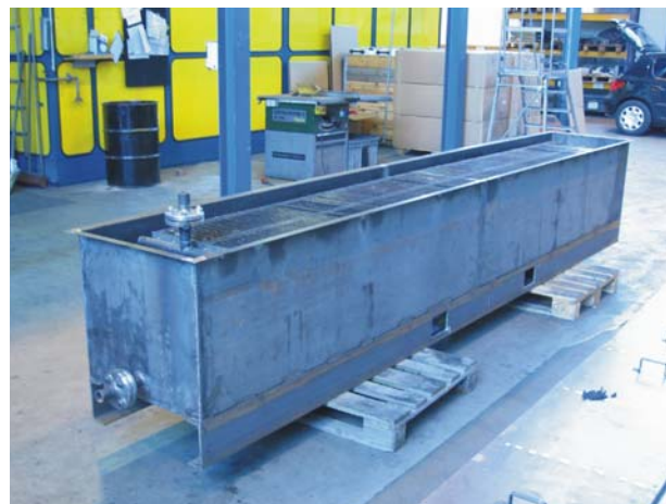
Abb.4: 100kW Distor Speicher mit geöffneter Abdeckung,
