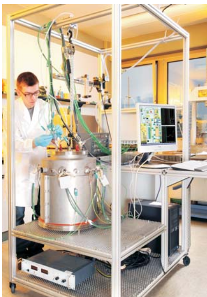
Kalorimetrische Messapparatur zur Charakterisierung von sensiblen und latenten Wärmespeichermaterialien
