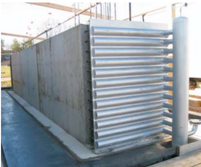
400 kWh Beton-Testspeichermodule ohne Isolation (gemeinsame Entwicklung mit Ed. Züblin AG)
