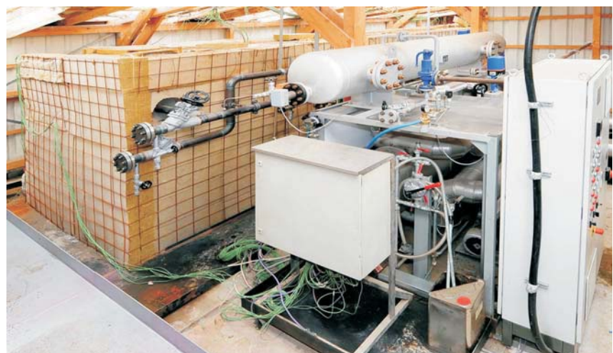
100 kW-Speichertestanlage für Testbetrieb bis 400 °C
