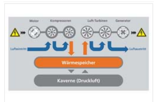
Funktionsschema eines adiabaten Druckluftspeicherkraftwerks
