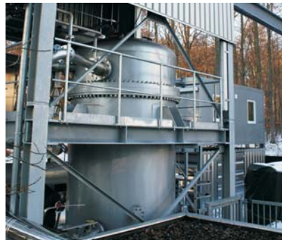
HOTREG-Testbett zur Untersuchung von Regeneratorspeichern (175 kW, 830 °C)
