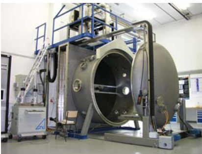
Zur Wärmedämmung werden keramische Schichten auf Turbinenschaufeln aufgedampft
