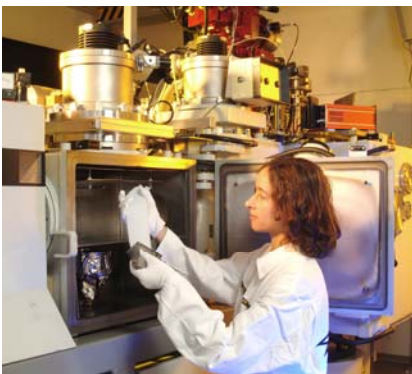
Zur Wärmedämmung werden keramische Schichten auf Turbinenschaufeln aufgedampft
