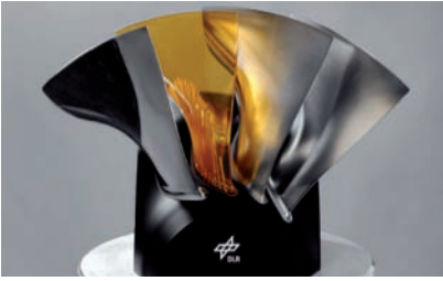
Demonstration unterschiedlicher Schaufelbauweisen in Hybrid- und MMC-Technologie
