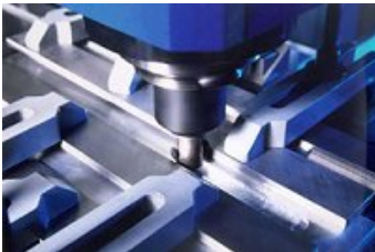
Prinzip des Reibrührschweißens
