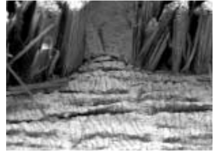
Versagen eines Schichtsystems.
