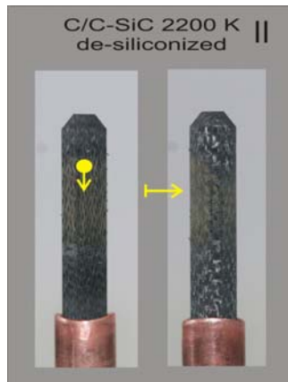
Schmelzphasen und Abrasion ab T>1600 K
