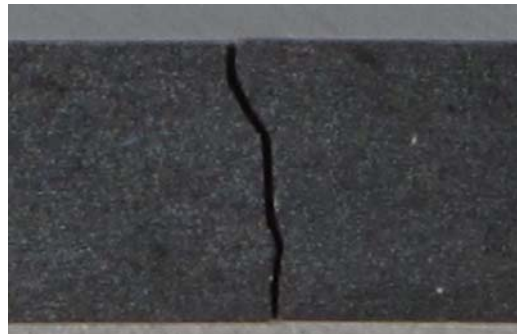
Monolithische Keramik, Biegeprobe
