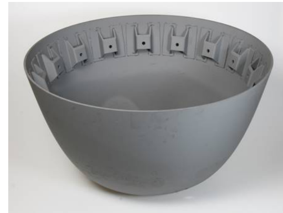
Nasenkappe aus C/C-SiC, Ø 700mm, Wandstärke 6mm
