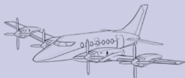
Für kleinere, 19-sitzige Flugzeuge, die Strecken bis zu 200 Kilometer zurücklegen, wäre ein vollständig batteriebetriebener Antrieb denkbar. Kraftstoff würde nur als Reserve für den Notfall mitgenommen oder wenn das Flugzeug ausnahmsweise eine längere Strecke fliegt.
