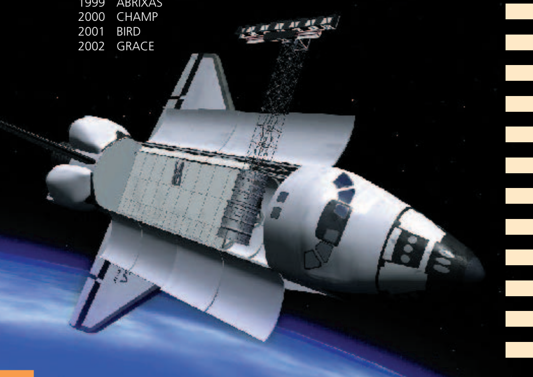
Abb. links: Space Shuttle mit ausgefahrter Radarantenne während der Mission X-SAR/ SRTM.
