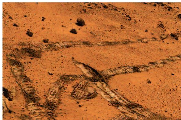
DLR-Radttest-Anlage simuliert unwirtliches Planetengelände Seite 58
