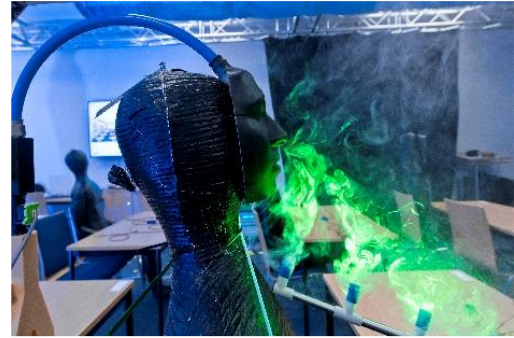
Abbildung 1: „Atmendes thermisches Menschmodell“ zur definierten Ausbringung von Aerosolen und Spurengasen (Quelle: DLR)
