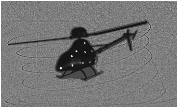
Mit BOS sichtbar gemachtes Wirbelsystem um einen Modellhubschrauber.
