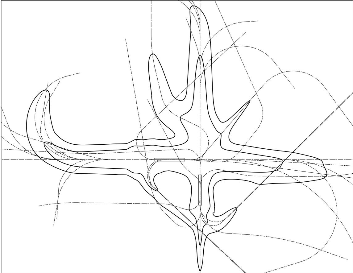
**Abb.5-1:** Kurven  $L_{eq(3),24h} = 55$  und  $60$  dB für den im Task MODEL 1 untersuchten *Hybrid Airport*. Die Kurven wurden nach dem AzB-Verfahren berechnet. Startbahnen und Flugstrecken (strichpunktiert) sind ebenfalls eingetragen.
