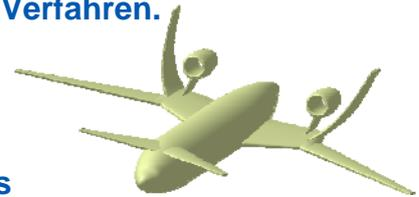
Voraussetzung für den Entwurf von Flugzeugkonfigurationen, die eine wirksame Abschattung der Triebwerksgeräusche erlauben, ist die Verfügbarkeit eines Werkzeugs zur Berechnung solcher Abschattungseffekte für reale Frequenzen bis 10 kHz (im Originalmaßstab). Hierzu ist ein Strahlverfolgungsverfahren am Besten geeignet, wenn es Beugungseffekte und den Einfluss einer überlagerten Strömung berücksichtigen kann. Die Entwicklung und Validierung eines solchen Verfahrens war Gegenstand dieser Aufgabe.
