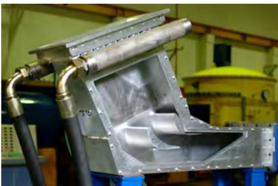
**Abbildung 2: Messstrecke des NGG mit drei hochskalierten Schaufelprofilen**
