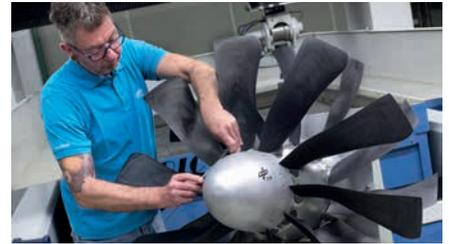
Flugzeugtriebwerk der Zukunft: gegenläufiger Verdichtertorator „CRISPMulti“
