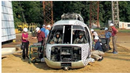
NASA-Crashtest einer Helikopter-Zelle mit CFK-Unterbodenstruktur vom DLR
