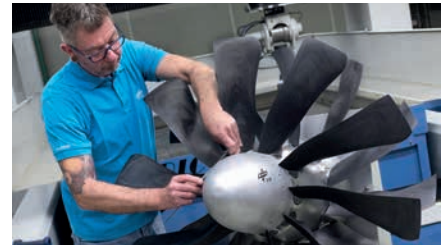
Flugzeugtriebwerk der Zukunft: gegenläufiger Verdichtertorator „CRISPMulti“
