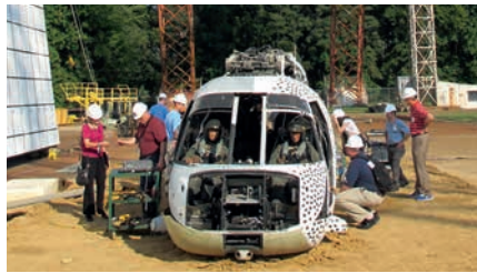
NASA-Crashtest einer Helikopter-Zelle mit CFK-Unterbodenstruktur vom DLR
