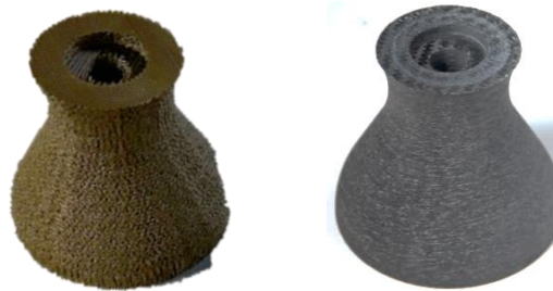
Lavaldüse: links additiv gefertigter Grünkörper, rechts in herkömmlicher Bauweise aus SiC.
