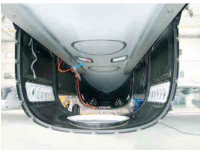
Der Belly Pod am Rumpf bietet Platz für wissenschaftliche Instrumente
