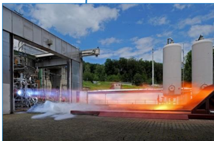
Versuche mit der Treibstoffkombination Flüssigwasserstoff und Methan am Prüfstand P3.
