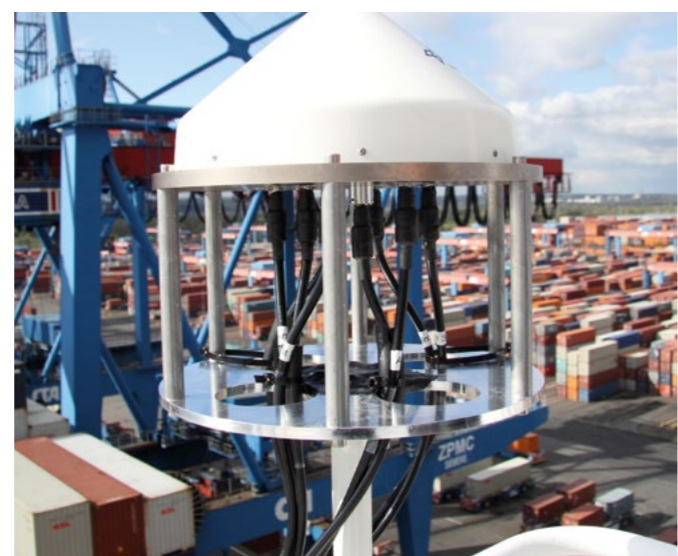
Messungen an Bord eines Containerschiffs zeigten, dass Satellitensignale häufig an Häfen gestört werden. Diese Antenne kann Störsender anpeilen, aber auch ausblenden.
