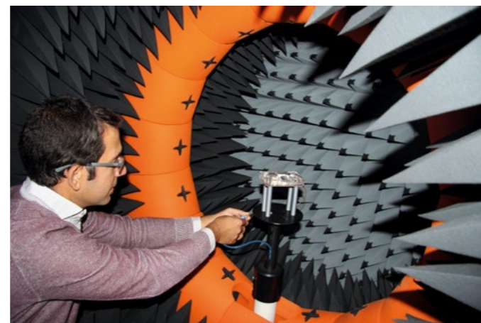
Dr. Stefano Caizzone aus dem DLR-Institut für Kommunikation und Navigation in Oberpfaffenhofen testet die sogenannte 3+1 Antenne. Diese ist speziell für den Empfang von Satellitennavigationssignalen an Bord ziviler Flugzeuge gebaut und ist robust gegen Stör- wie auch Täuschsender.
