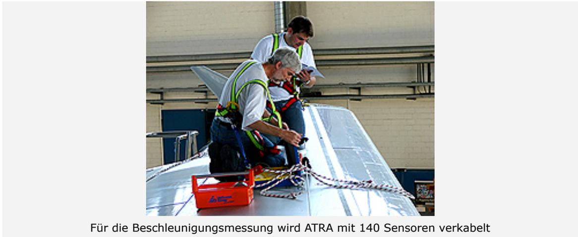
Für die Beschleunigungsmessung wird ATRA mit 140 Sensoren verkabelt
