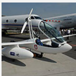
Fliegen mit der Brennstoffzelle: Antares
